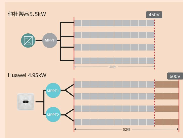
なぜ300%以上過積載が可能？ 分岐ケーブルを使用 最大入力電圧600V スtring毎にパネル3枚増加
