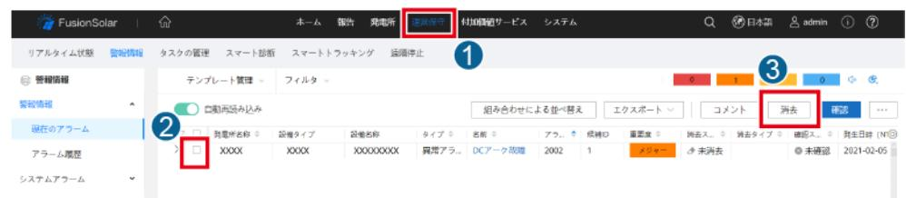
PV発電所管理権限を持つ所有者アカウントに切り替えます。ホームページで、PV発電所名をクリックしてPV発電所ページに移動し、表示に従って [OK] をクリックしてアラームを消去します。
