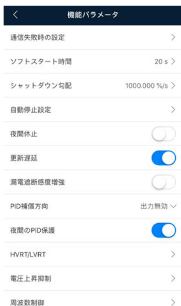
図 8-10 機能パラメータ(設置業者)
