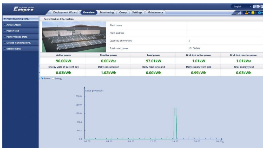
Figur 6-3 Information om anläggningens drift (med effektmätare men utan batteri)
