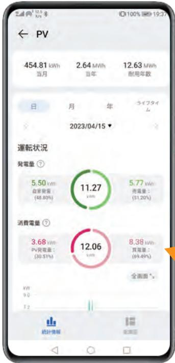
ホーム画面では現在の発電量・蓄電池充放電・蓄電池残量・消費電力・電力会社買電/売電電力まで一目瞭然です。タップで詳しい状況も確認でき、電気料金単価を設定して経済メリットも確認できます。
