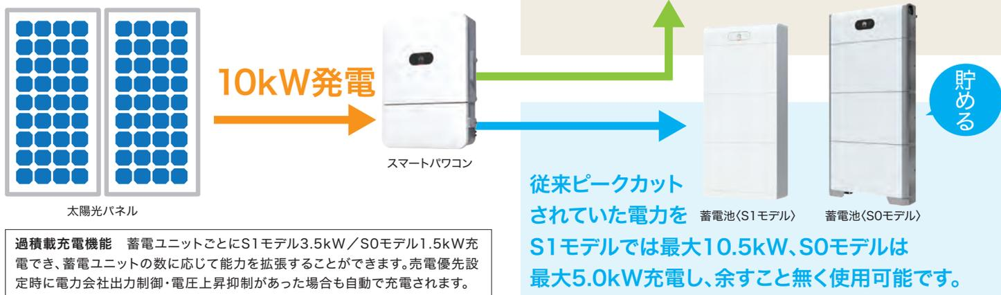
**過積載充電機能** 蓄電ユニットごとにS1モデル3.5kW/S0モデル1.5kW充電でき、蓄電ユニットの数に応じて能力を拡張することができます。売電優先設定時に電力会社出力制御・電圧上昇抑制があった場合も自動で充電されます。
