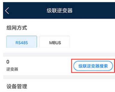
图 6-23 设置逆变器级联
