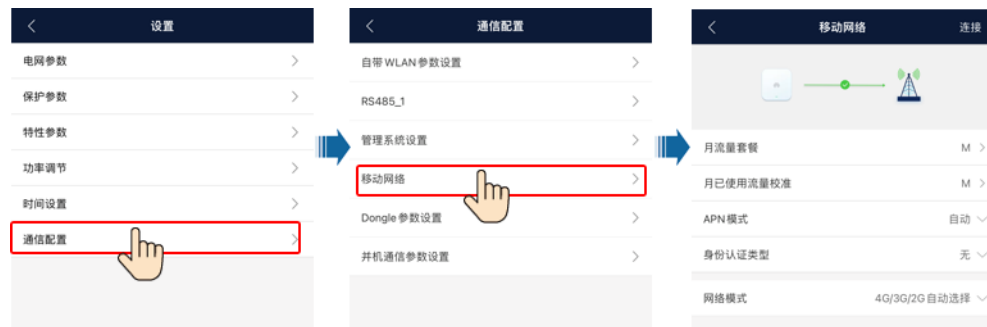
图 6-6 逆变器通信配置
