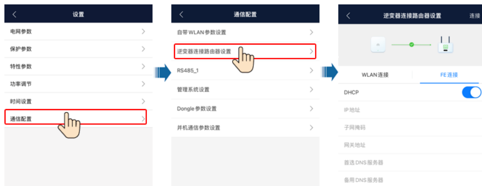
图 6-9 逆变器通信配置
