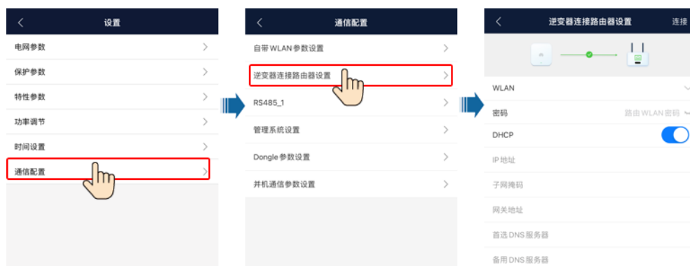
图 6-3 逆变器通信配置
