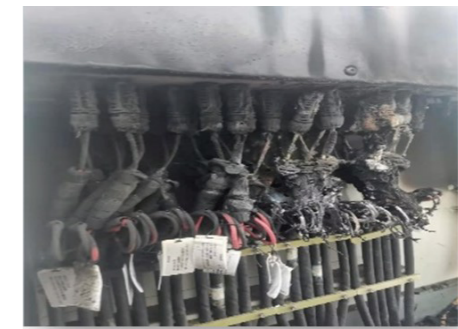
图17 端子过温导致的起火事故
