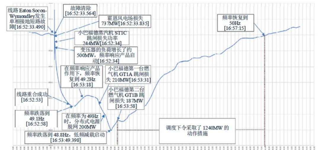
图5 英国8·9大停电事故过程的事件时序与频率变化
