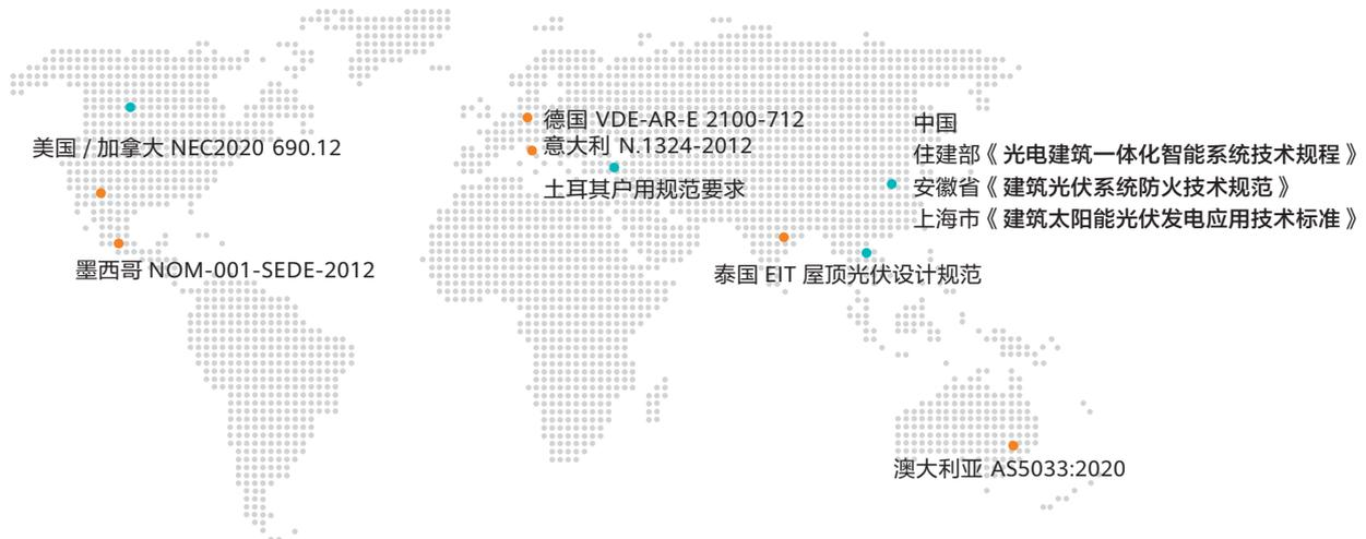
美国 NEC 2020 690.12 标准具体规定如下：在 1 英尺（30 厘米）范围以外，光伏输出电压在 30s 内降到 30V 以下；在 1 英尺（30 厘米）范围以内，光伏输出电压在 30s 内降到 80V 以下；要求组件级关断能力；强制可靠性急停，要求具备自检功能和单点故障快速关断功能不丧失。
