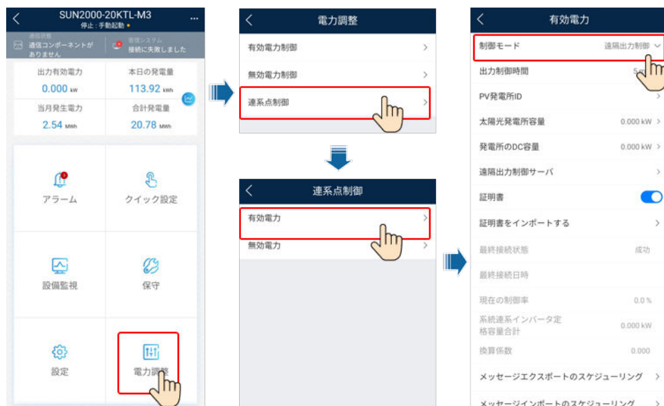
図 C-1 遠隔出力制御パラメータを設定
