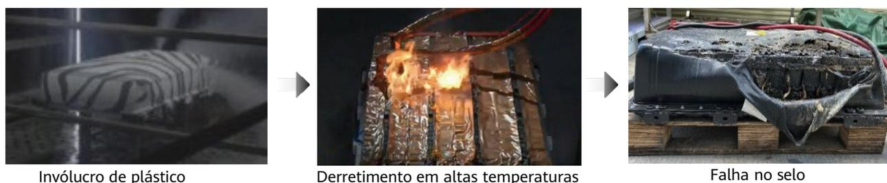
Figura 19 Derretimento do conjunto devido à fuga térmica
