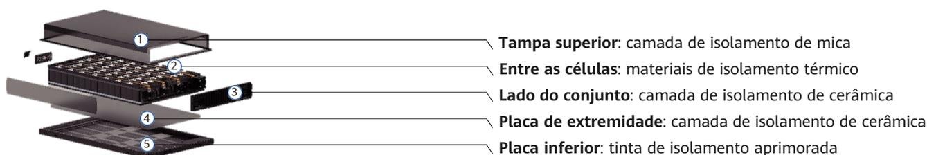
Figura 25 Isolamento de seis lados para o conjunto de baterias
