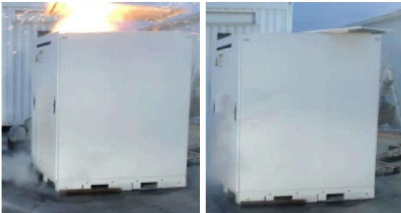
Figura 51 Teste de alívio de explosão em andamento
