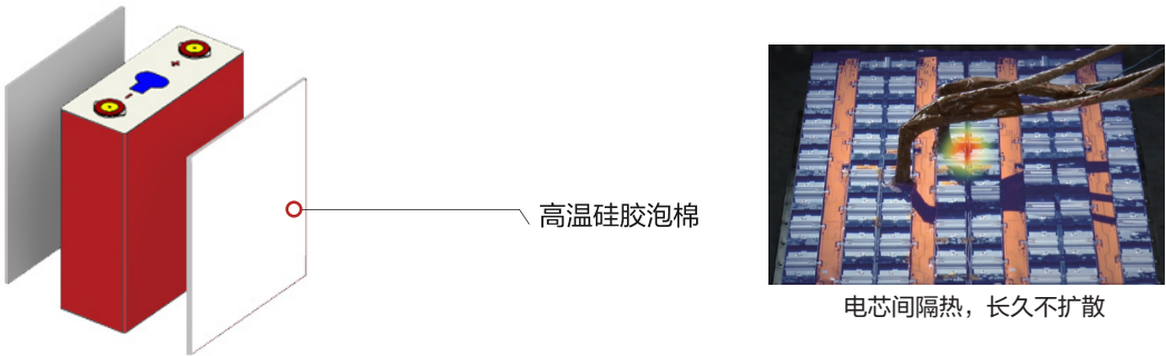
图30：电芯间隔热设计
