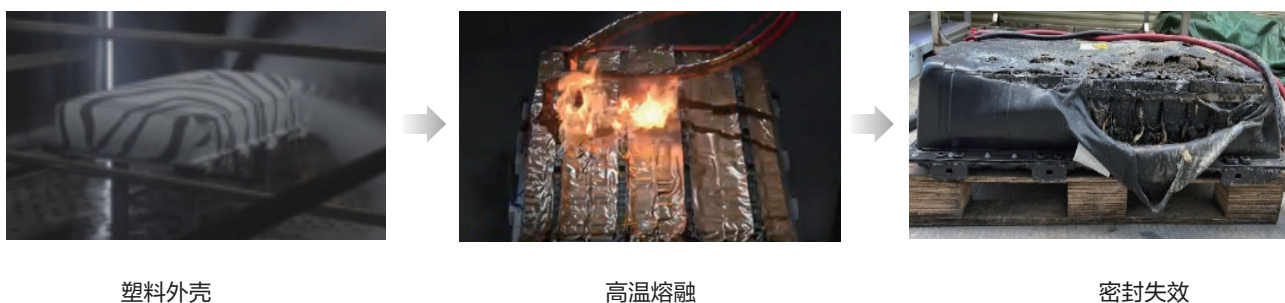
图19. 电池包热失控熔融示意图
