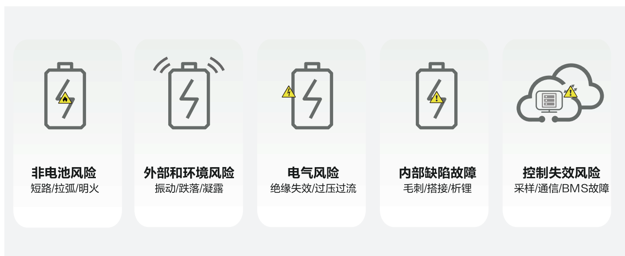
图7. 电气短路故障产生的原因
