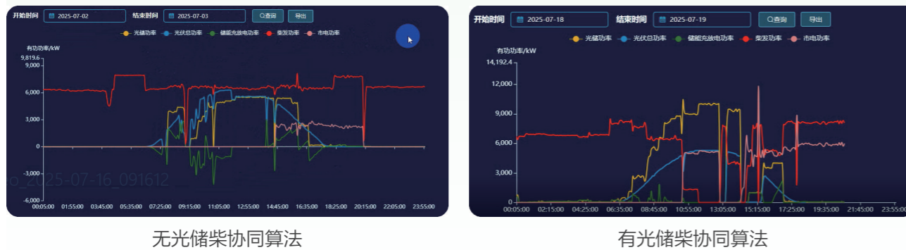
图 2-13：刚果金马本德矿山微电网项目光储柴协同工作曲线对比
