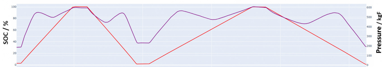
图 17：膨胀力与电压对比曲线
