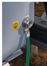
接地線 3.5sqもしくは5.5sq M6ボルトトルク値: 5N・m
