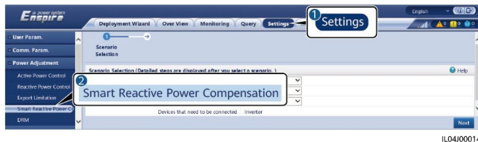
Εικόνα 6-53 Ρύθμιση παραμέτρων για την έξυπνη αντιστάθμιση άεργου ισχύος
