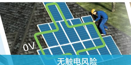
每块太阳能板可快速关断, 逆变器集成专业防触电模块
