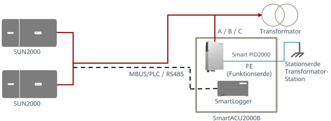
1. Die Smart PID2000-Lösung kann in Installationen bereitgestellt werden, die normalerweise über einen Transformator an das Stromnetz angeschlossen sind und OHNE Neutralleiter ausgeführt werden.
